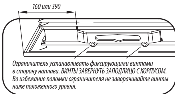
Рисунок 1 - Установка узлов со стороны правой боковой стойки
