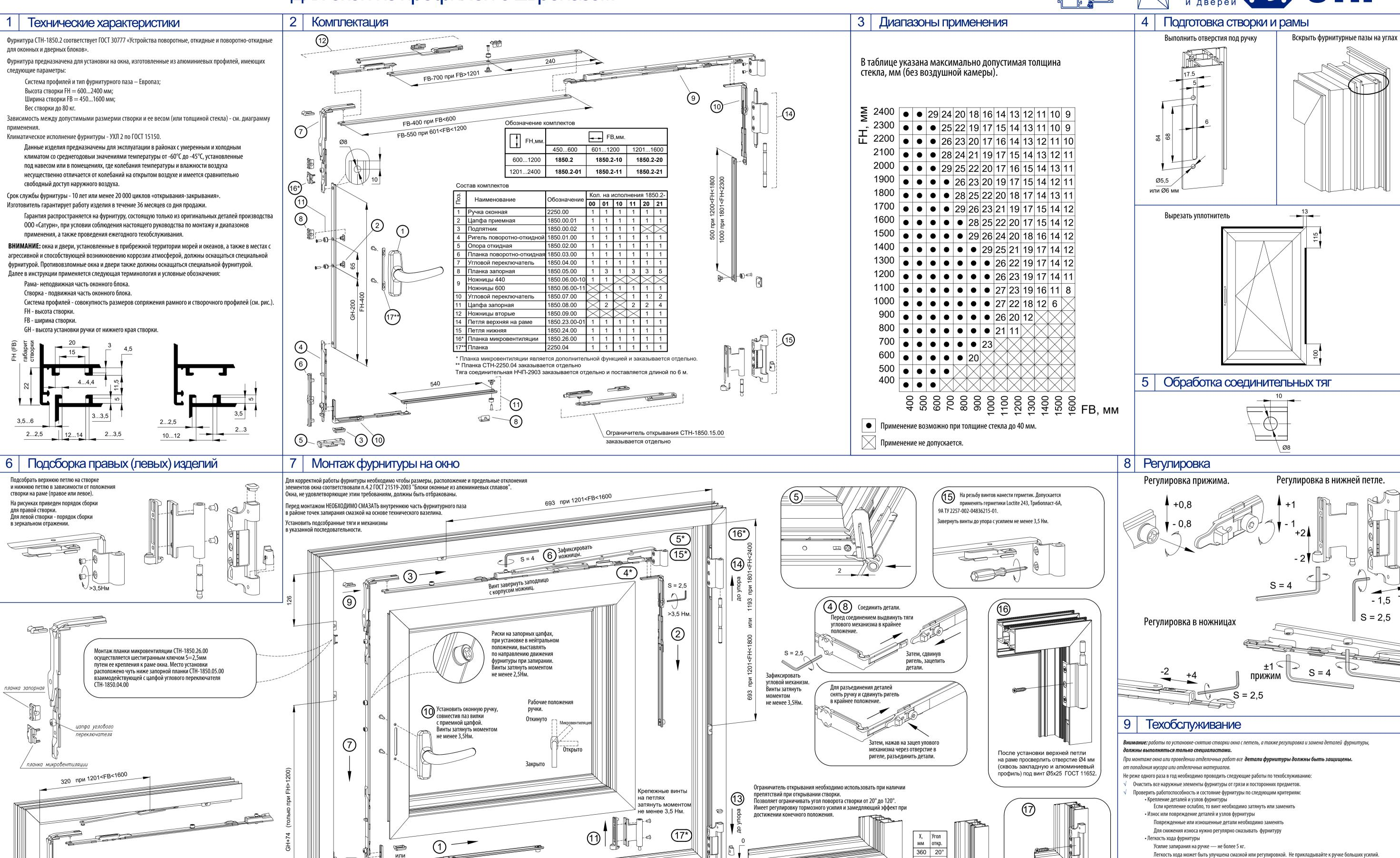
Установить ответные планки. Винты ответных планок затян
